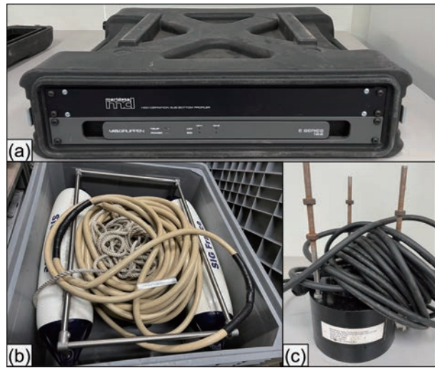
(a).信号处理单元;(b).Boomer 轰鸣器;(c).Chirp 声呐脉冲
