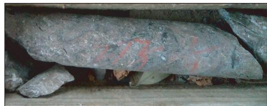
图 8 似糜棱状富矿石(热液隐爆细屑岩)(河元背 ZK17-3 钻孔,岩心直径 36 mm)
