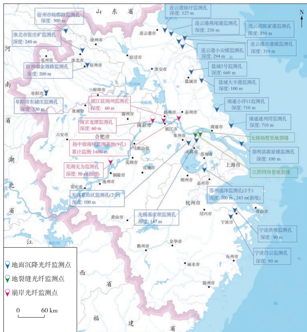
图 14 长三角地区地面沉降、地裂缝和长江崩岸监测分布图
